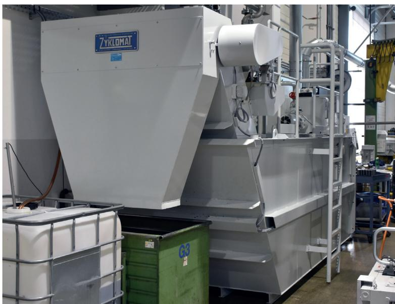
Eine über Stefan Schröder Industrievertrieb bezogene Zyklomat®-Zentralanlage der Baureihe ZKR versorgt zwei Schleifmaschinen mit vollautomatisch aufbereitetem Kühlschmierstoff. Sie ist für den Anschluss einer weiteren Maschine vorbereitet
