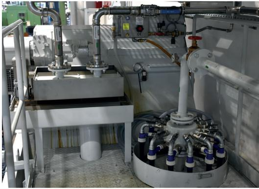
(re.) Ein Plattenwärmetauscher hält die KSS-Temperatur konstant bei 22 °C und minimiert dadurch den KSS-Verlust durch Verdunstung
